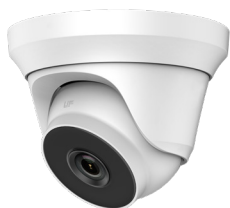
GT2CAM Externe turret bewakingscamera voor GT buitenpost, manual 2.8-6mm, 40m IR, IP66, 12V DC/500mA, Ø 127,92 mm x 102,26 mm (*)
