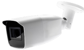
GTCAM Externe bewakingscamera voor GT-deurpost, vari Focal 2.8-12mm, 40m IR, IP66, 12V DC/500mA, 256.4 mm x 83.3 mm x 78.2 mm (*)
