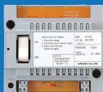
GT-BC Buscontrole eenheid (7 DIN modules)
